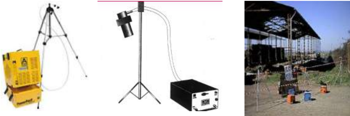
Figura 2: Esempio di installazione centralina di campionamento ambientale
