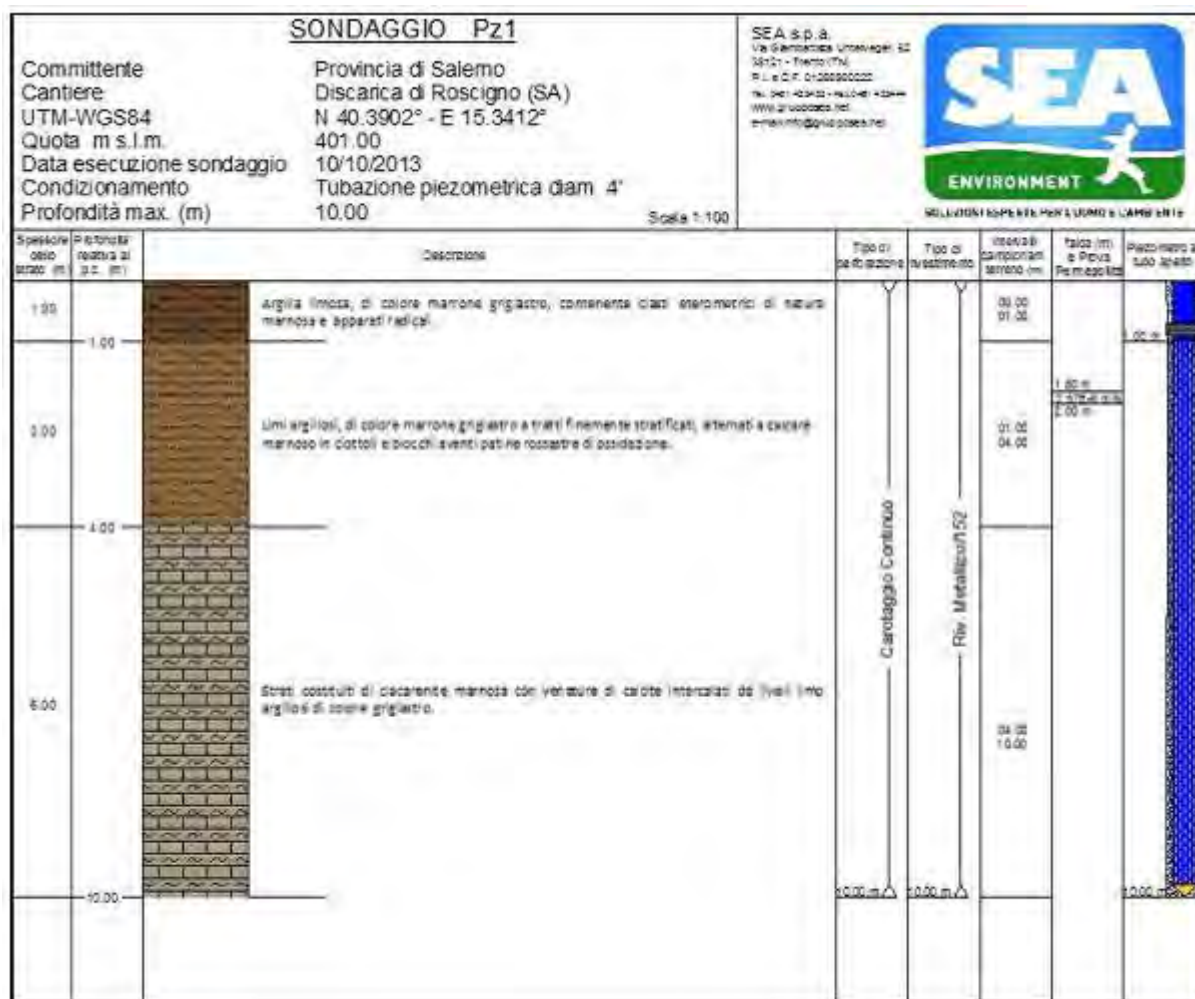
Fig. 5 – Esempio di restituzione grafica dei dati stratigrafici
